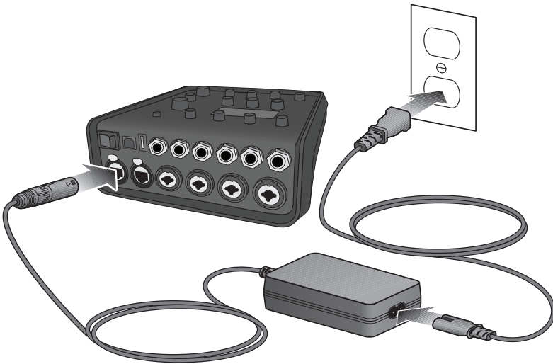
Figura 11. Conexión del T4S a la fuente de alimentación
